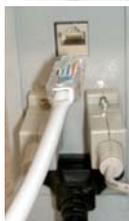
5. ЭК **DoCash 1050** имеет сетевой интерфейс Ethernet. Подключите сетевой кабель с разъемом RJ-45 к соответствующему разъему электронного кассира.
