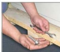
2. Извлеките транспортировочные болты из отверстий. Снимите аппарат и установите на нужное место.
