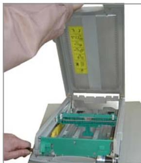
4. Закройте крышку кассеты до щелчка, поверните и вытащите ключ.
