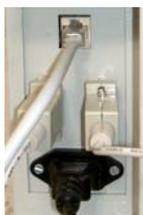
6. Полное подключение электронного кассира с использованием одного разъема Ethernet и двух разъемов RS 232.
