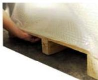
1. С нижней части основания поддона, на котором установлен электронный кассир, открутите два транспортировочных болта.
