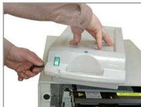
3. Поднимите крышку кассеты вверх, нажав зеленую кнопку.
