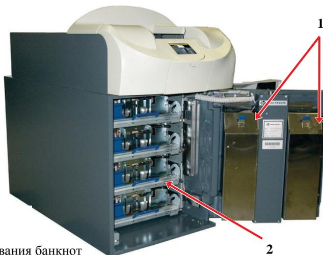
1. Ручные депозитные кассеты в сейфе (только для прочного сейфа коробчатого типа)
