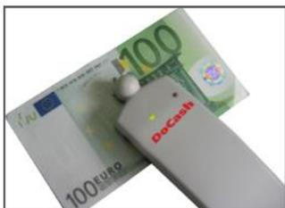
**DoCash M** - это опциональный аксессуар, дублирующий встроенную функцию детектора **DoCash BIG D**. Подключив его к детектору, Вы получаете возможность контролировать наличие и положение магнитных меток на исследуемой банкноте (документе) при помощи светового и звукового сигналов.
