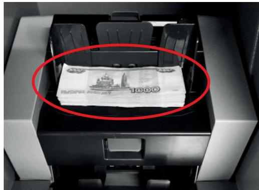
Внесение банкнот в устройство должно осуществляться строго по широкой стороне банкноты! В зависимости от варианта управляющего ПО, слистывание банкнот может начинаться автоматически или по отдельной команде (см. инструкцию пользователя).
