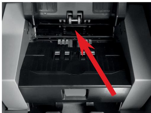
4. Нажав на рычаг 2 (см. фото) поднять крышку нижнего приёмного тракта. Далее, извлечь купюры или убедиться в их отсутствии в нижнем приёмном тракте, после чего закрыть крышку.
