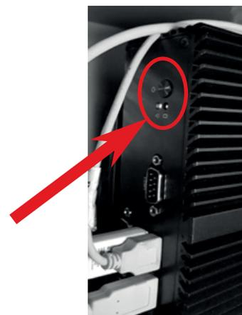
Подача питания на ИБП (источник бесперебойного питания) происходит автоматически, после подключения **DoCash ADM-100M** к электросети.
