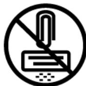
Данное устройство способно перерабатывать канцелярские скрепки, но не предназначено для их переработки на ежедневной основе. Настоятельно рекомендуется предварительно удалять с бумаги канцелярские скрепки перед загрузкой бумаги в устройство.
