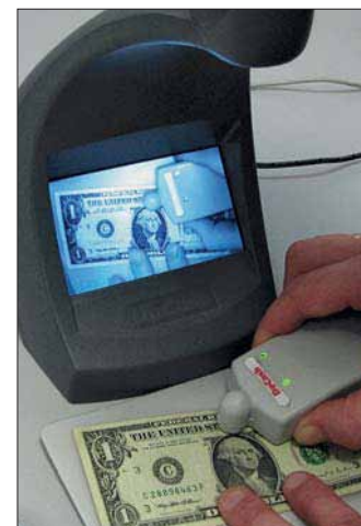
Визуализатор магнитных и ИК-защитных признаков DoCash M
