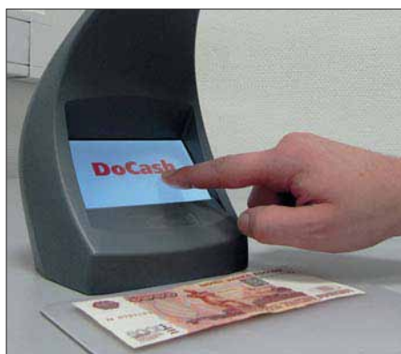
Включение детектора, управление настройками и режимом просмотра спецэлемента «М» сенсорное
