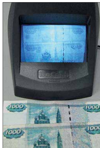
Сравнение изображений, видимых в ИК-свете: фальшивой купюры (внизу и слева) и подлинной (вверху и справа)
