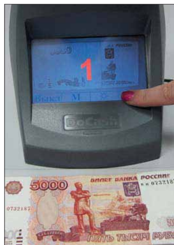
9-ступенчатая настройка яркости и контрастности позволяет работать на детекторе при любом освещении
