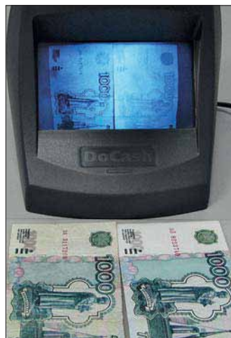
Сравнение изображений, видимых в ИК-свете: фальшивой купюры (внизу и слева) и подлинной (вверху и справа)
