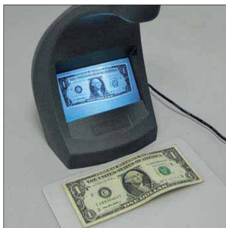
Цифровая камера с автофокусировкой формирует четкое изображение банкноты
