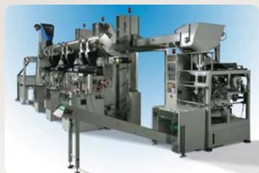
3-х канальная система **Bullion Pack System (BPS)** используется для обработки больших объемов монет.
