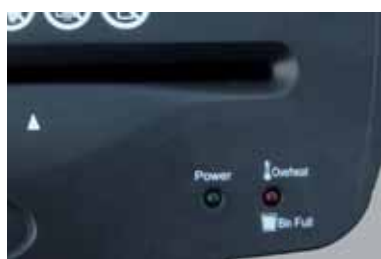
Датчик перегрева и заполненности корзины
